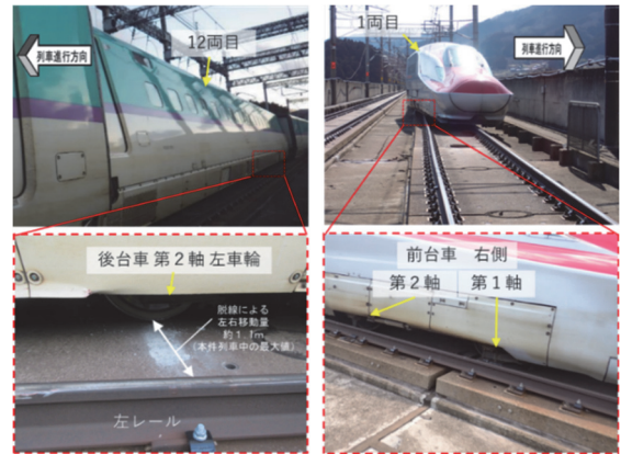
図1 事故現場の状況
