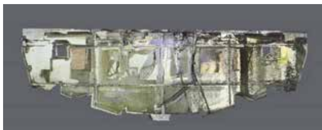
構造物により全体を写真撮影できない船内隔壁の再現
