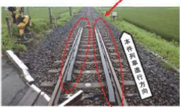
図 脱線防止ガード及び監視カメラの設置状況
