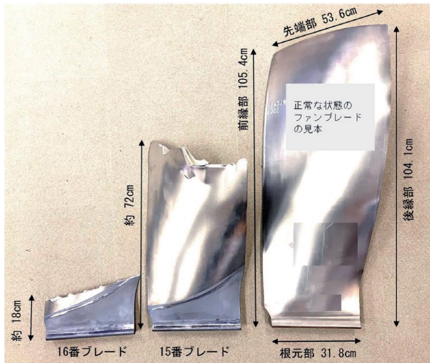
図2 ファンブレードの破損状況
