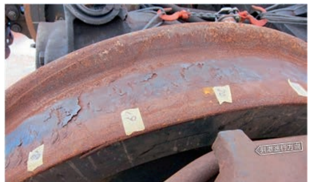
車輪の踏面剥離の状況
