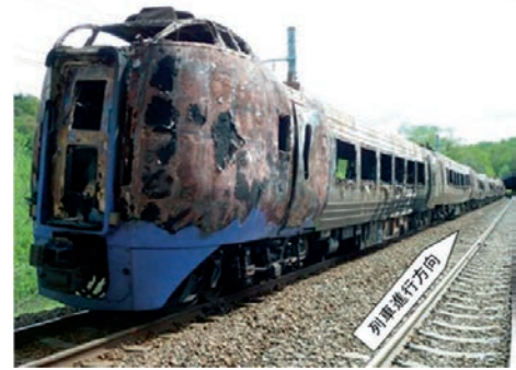
車両の焼損状況
