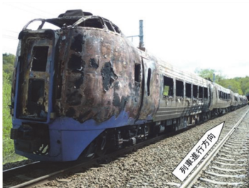
車両の焼損状況
