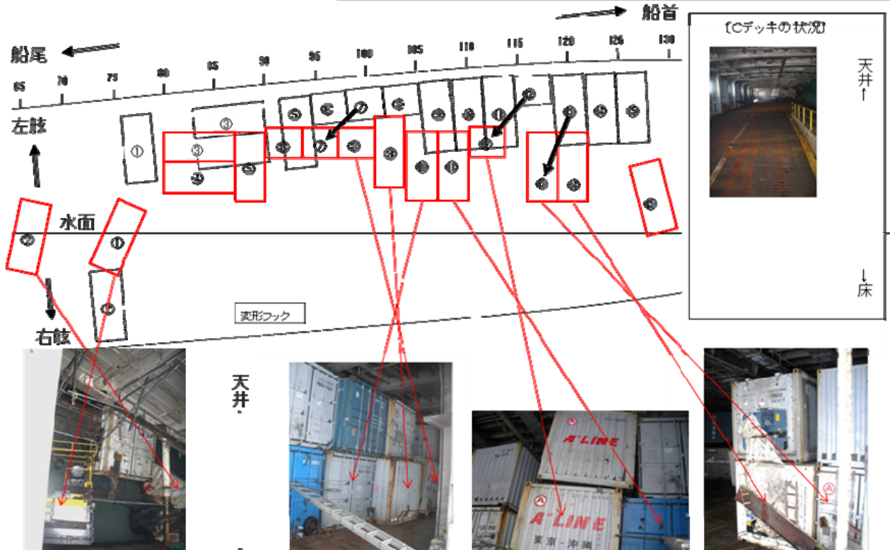
コンテナ及びシャーシの移動状態
