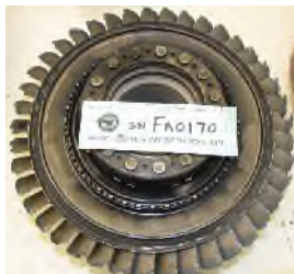
損傷した HPT ブレード
