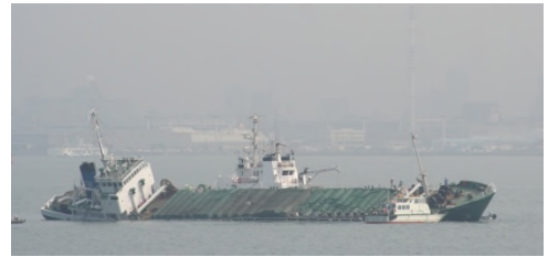
衝突後傾斜した B 船船体
