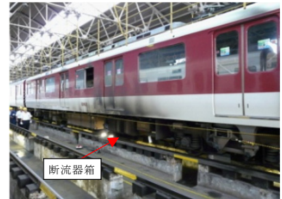
本件車両の損傷状況
