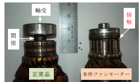
整流子側の軸受の状況
