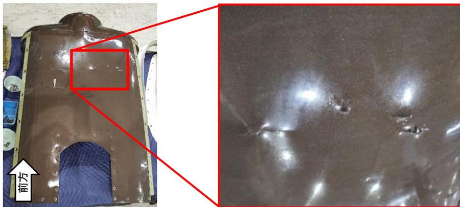
図2 右エンジンの上部カウリングの損傷状況
