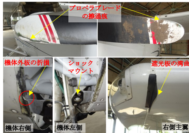
図3 主な損傷箇所
