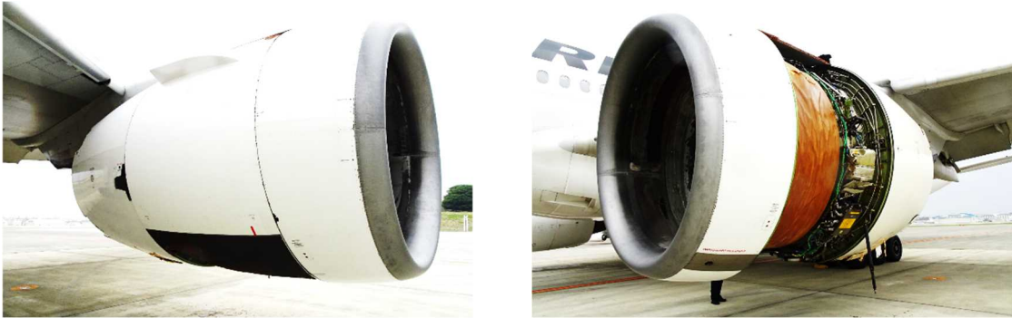
図5 エンジン・カウルの損傷状況
