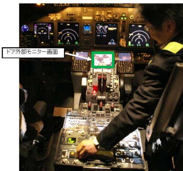
飛行中のドアロックセレクターの操作
