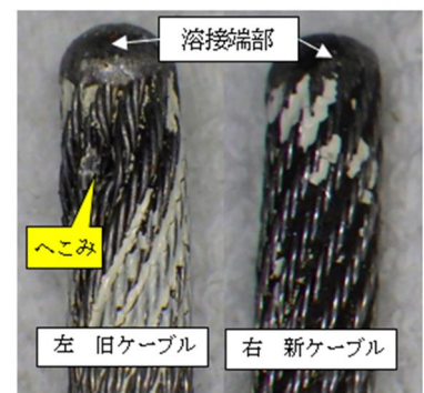
図8 ケーブル索端の比較
