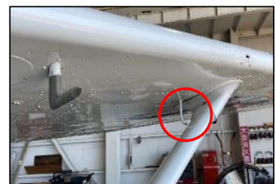
図6 燃料タンクベントの出口
