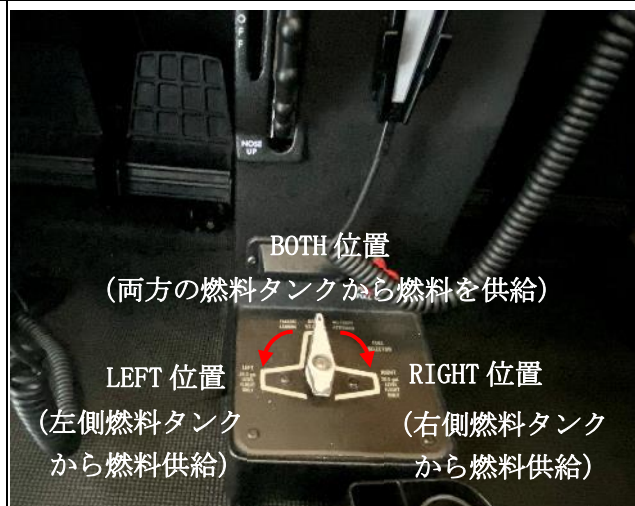
図7 燃料セレクトター・バルブ・ハンドル 図8 FUEL INJECTION SERVO
