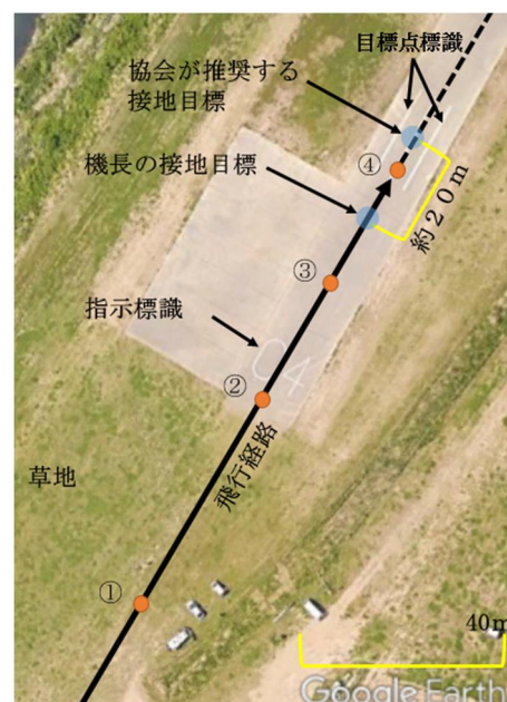
図2 接地の状況(口述による)
