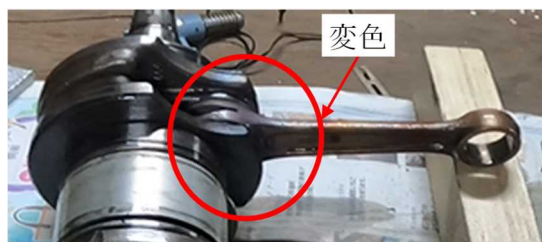
図5 コネクティングロッドの変色
