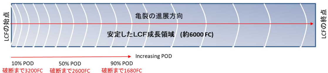
図30 安定したLCF成長領域の亀裂の進展及びPOD
