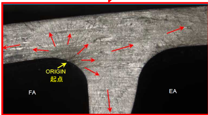
図14 疲労破壊の起点領域
