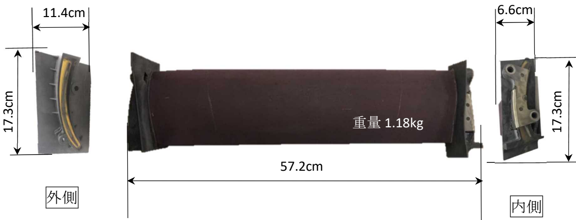
図7 FEGVの損傷状況
