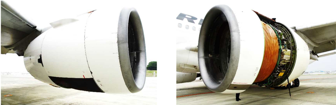
図5 エンジン・カウルの損傷
