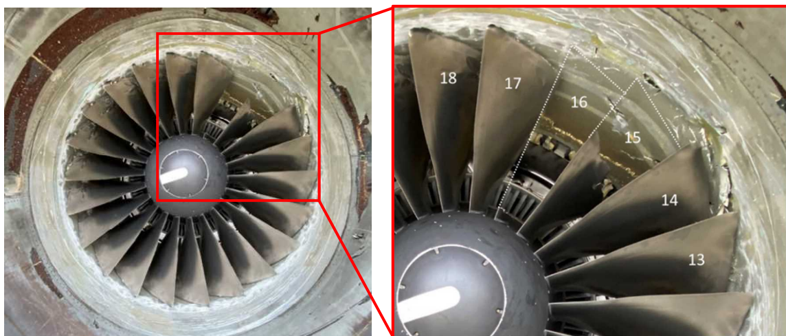
図4 ファンブレードの破断
