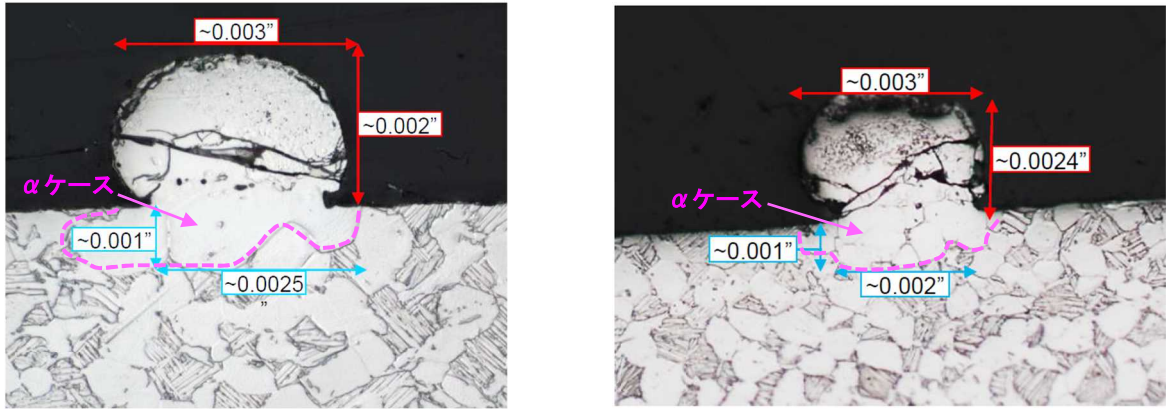
図 2 3 起点箇所以外のノジュールの溶着状態
