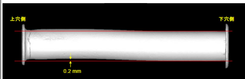
図9 異常フロートのインサートの歪み
