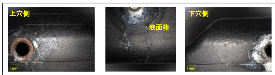
図 11 透明～白色物質の付着状態（異常フロート）
