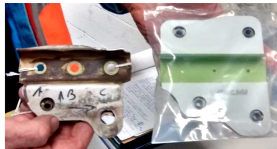
破損したブラケット 改良型ブラケット
