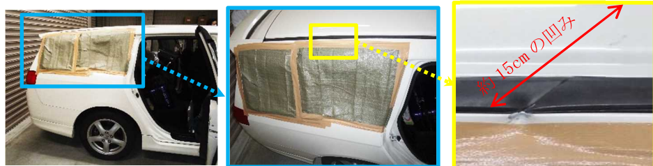
写真2 車両の損壊状況
