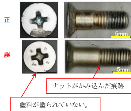
写真4 正規部品と誤部品
