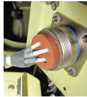
適切に処置されたレセプタ クル (配線を固定する部品 (橙色の部品) を使用)
