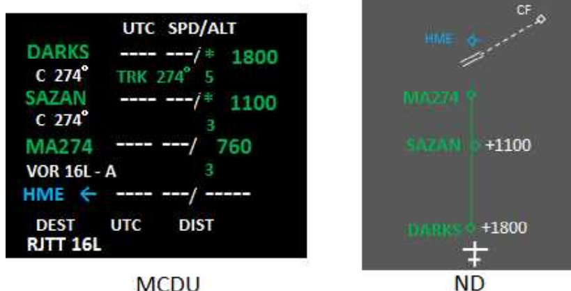
図9 登録されたVOR A進入方式用のNAVデータ表示（イメージ）
