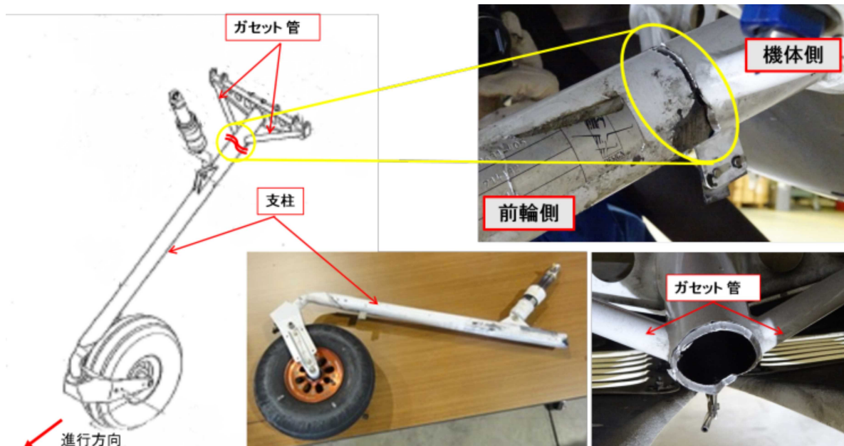
図2 前脚構造と支柱破断箇所
