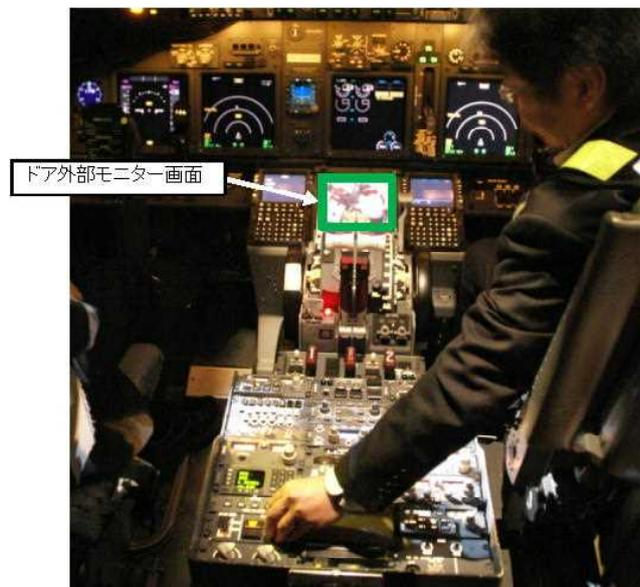
飛行中のドアロックセレクターの操作
