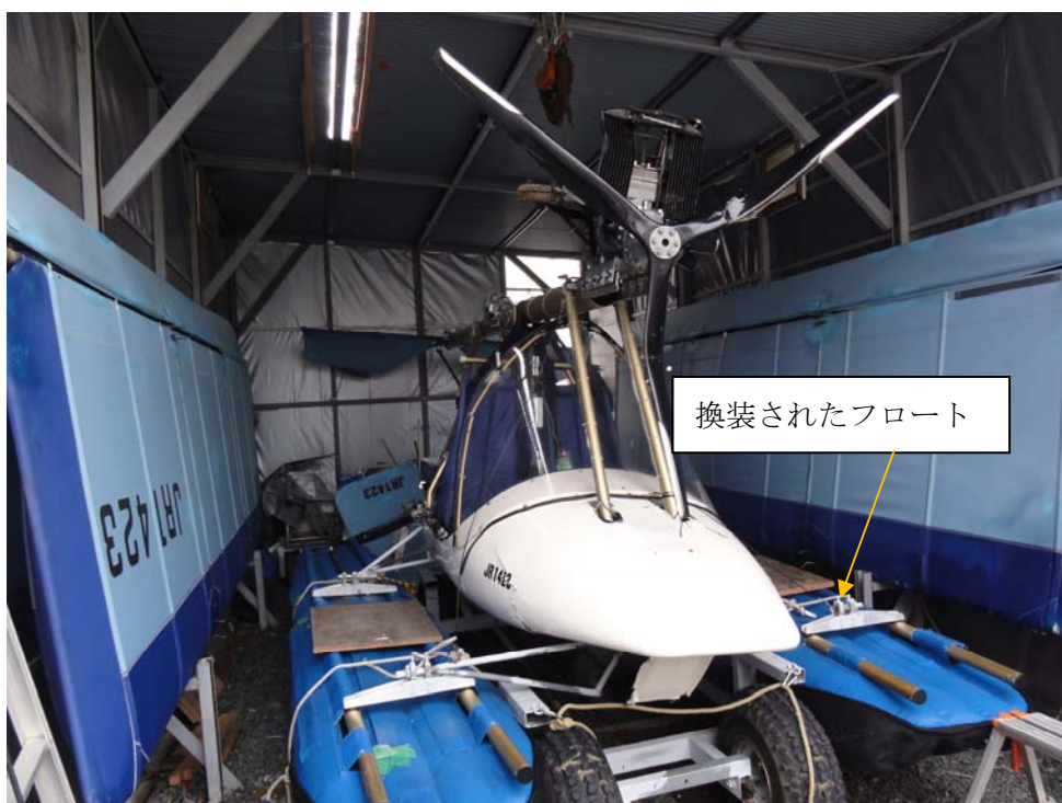
※重大インシデント後、主翼及び垂直尾翼を取り外した状態
