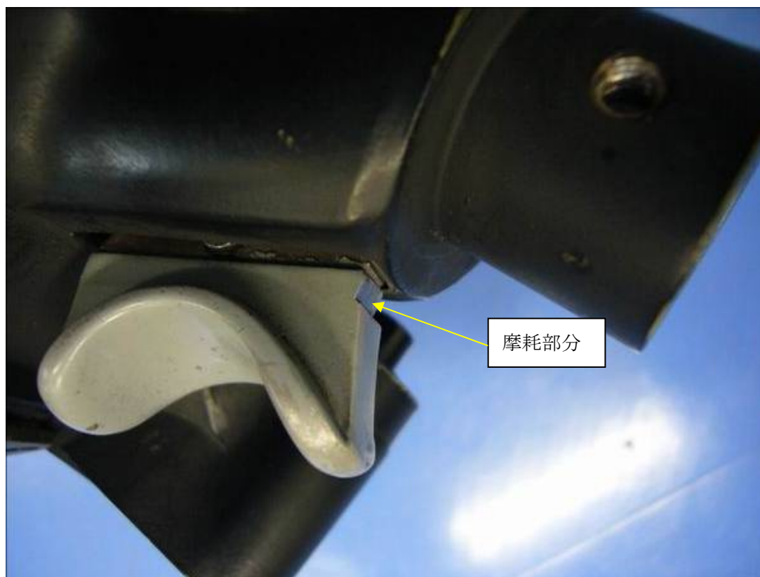
写真4 摩耗部分の干渉
