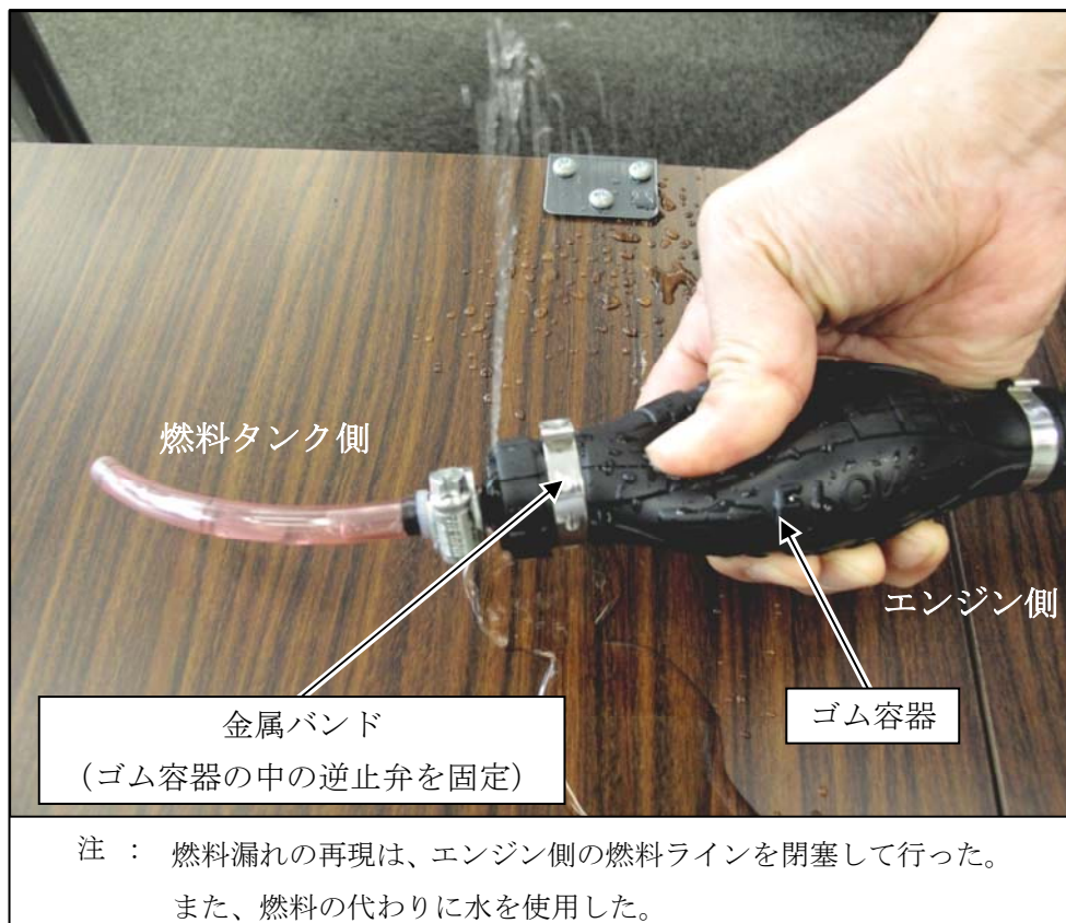
写真3 プライマーバルブからの燃料漏れ (機体調査時の再現)
