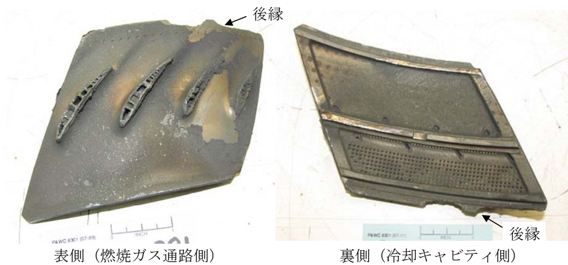
写真18 脱落したLPTベーン・セグメント#2 内側ドラム
