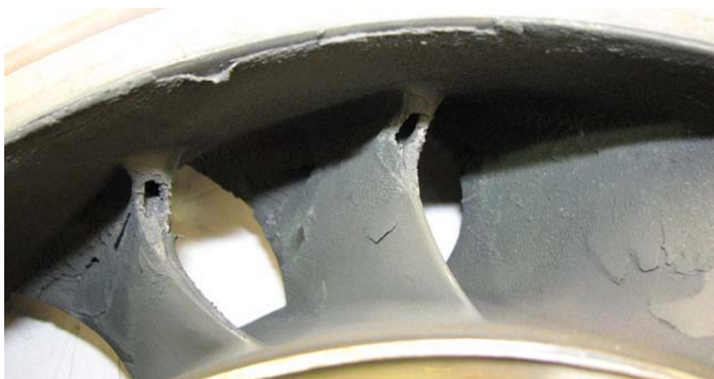
インタータービン・ベーンの熱腐食 (枠内拡大)
