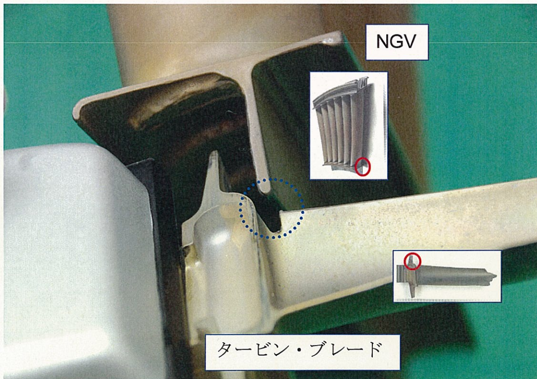
写真8 LPT STG-2 のタービン・ブレード衝突痕
