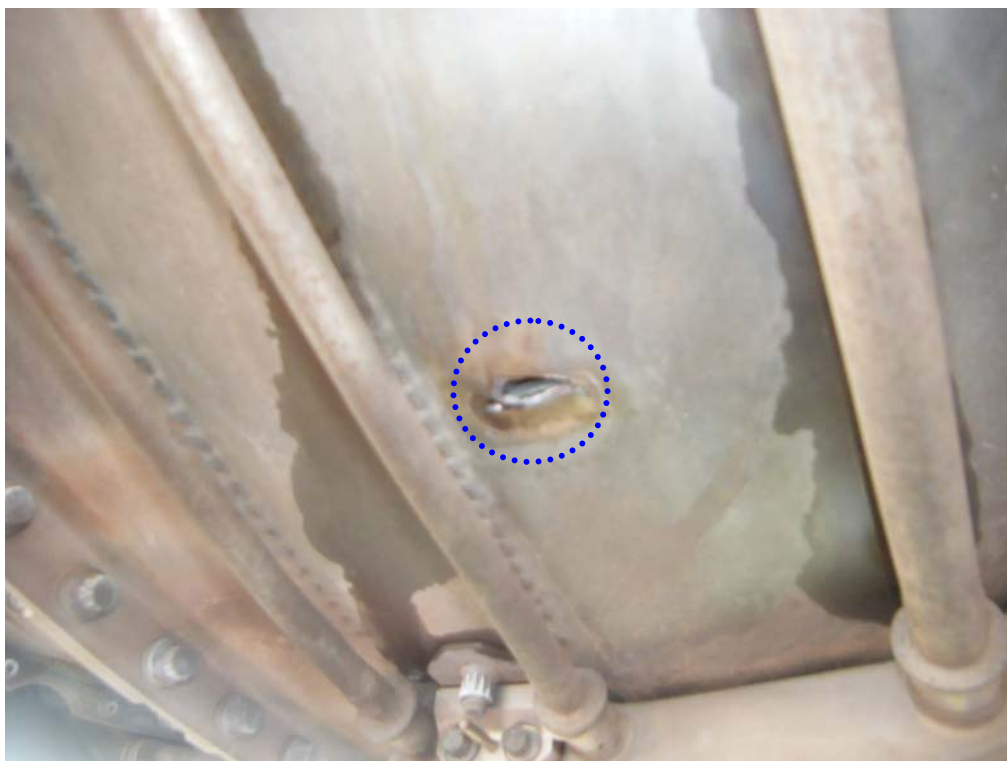
写真6 No. 3 エンジンの損傷したL P Tケーシング
