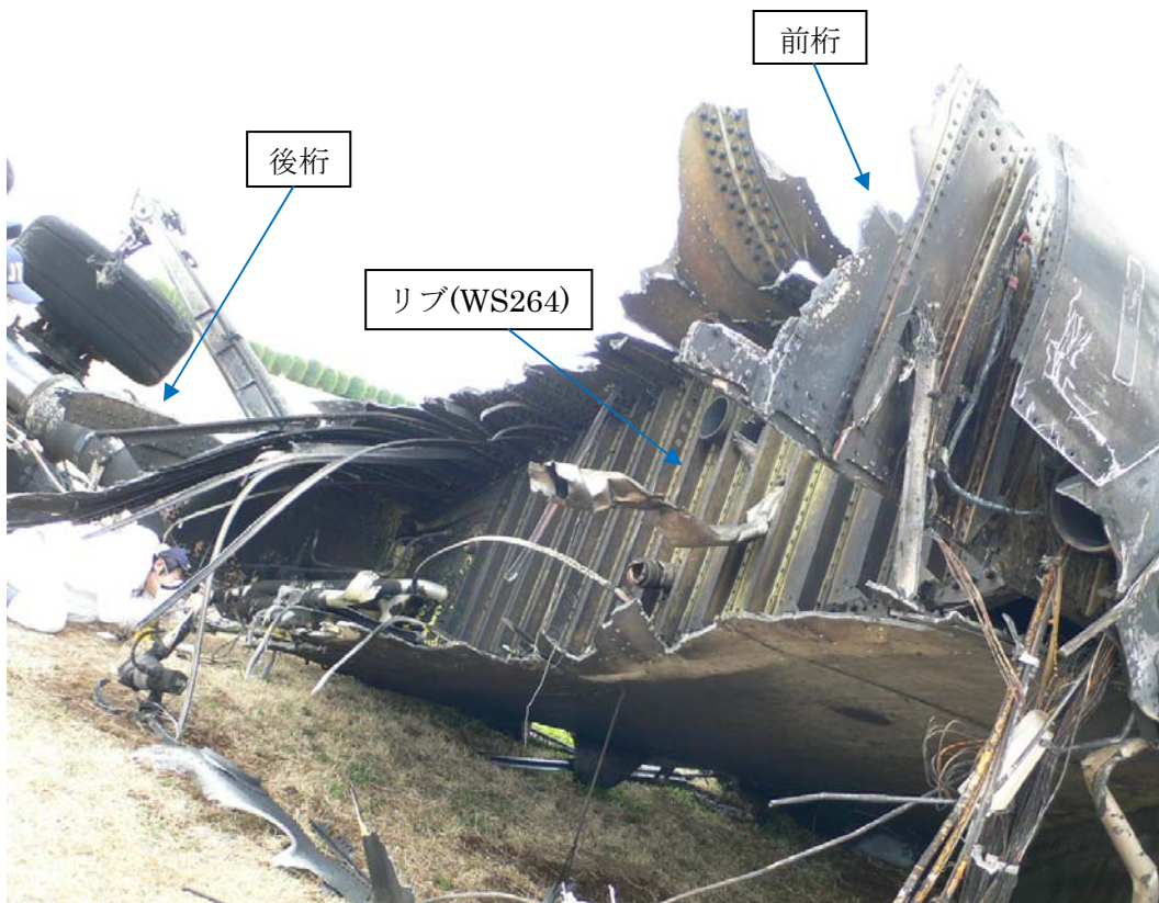
写真4 左主翼破断部(後方視)
