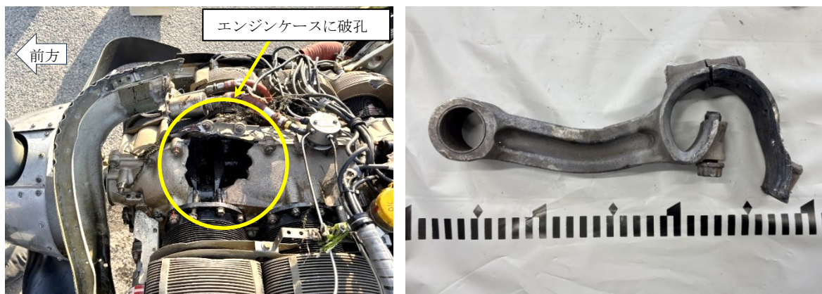
図4 同機のエンジン及びエンジンの内部部品(コネクティングロッド)
