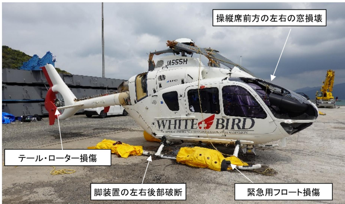
図1 同機の損壊の状況（右前方）
