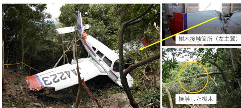
図2 事故発生時の機体の状況と左主翼損傷状況
