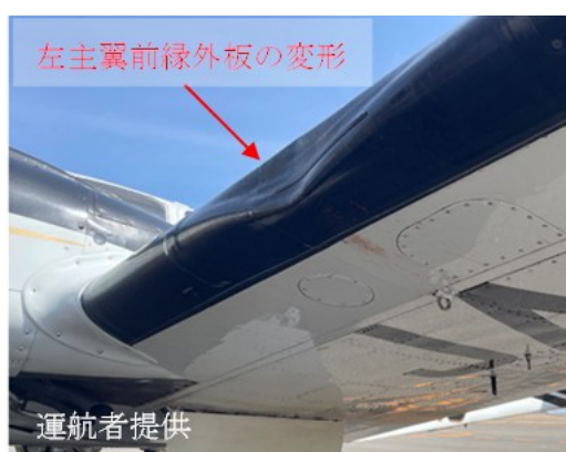
図3 損傷箇所（左主翼前縁外板）
