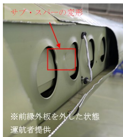
図4 損傷箇所（左主翼サブ・スパー）
