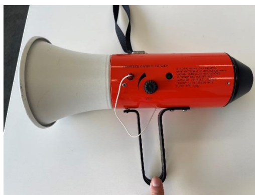
図3 B機に搭載されていたものと同型式の拡声器（出力：2 W）
