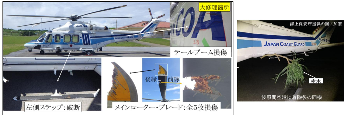
図3 機体の主な損傷状況等
