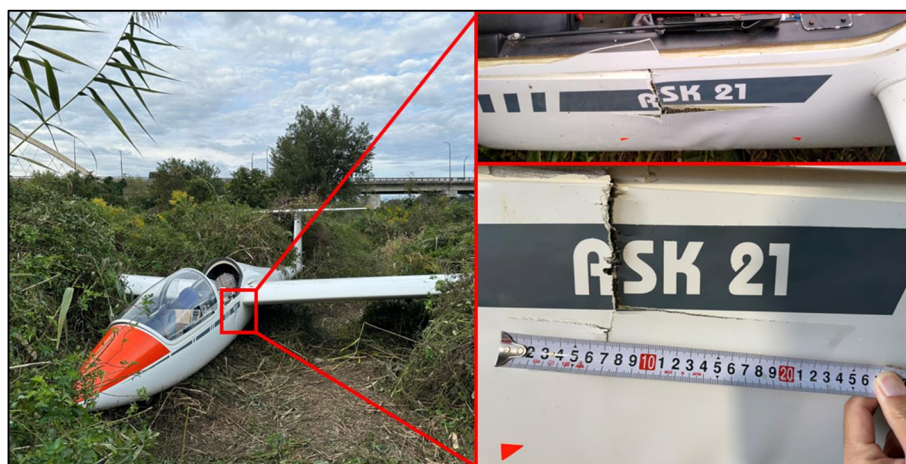
図2 主要な損傷状況 (胴体左外板)
