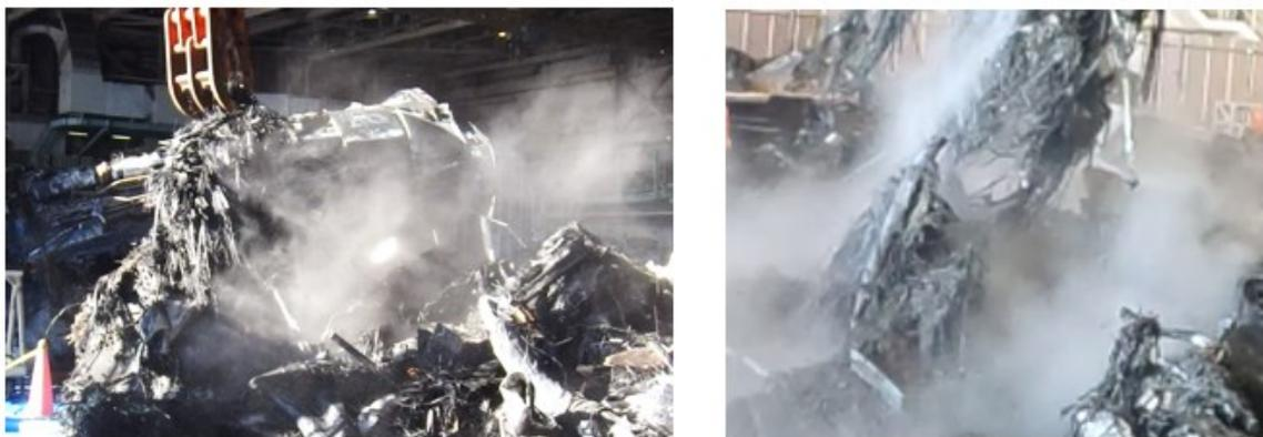
図3 4 - 2 CFRP焼損後の粉塵の状況
