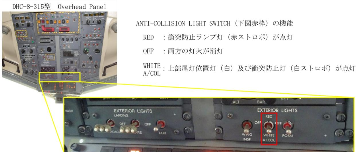
図 1 1 - 2 DHC - 8 - 3 1 5 型機外部灯火操作スイッチ
