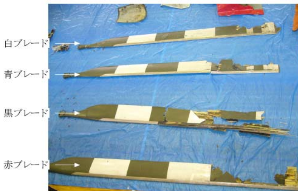
写真4 メイン・ローターの損壊状況
