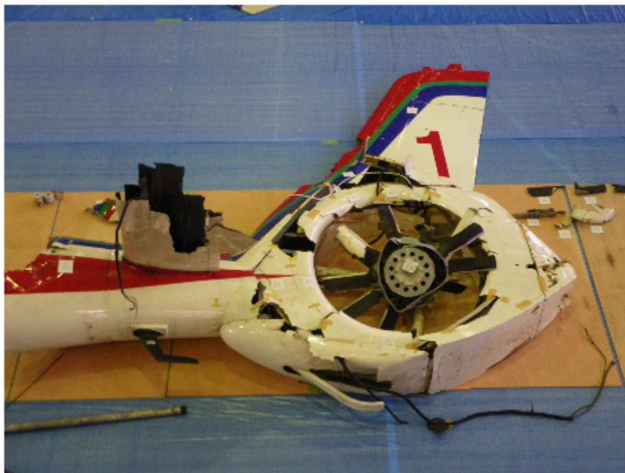
写真3 フェネストロンの損壊状況
