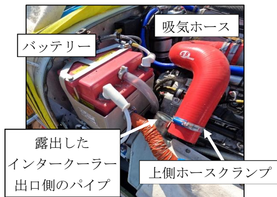
図5 事故後の吸気ホースが外れた状態
