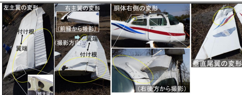
図6 機体の損傷状況1
