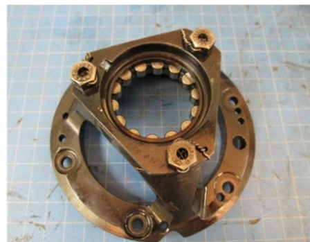
図I No.2 1 ローラー・ベアリングの状態
