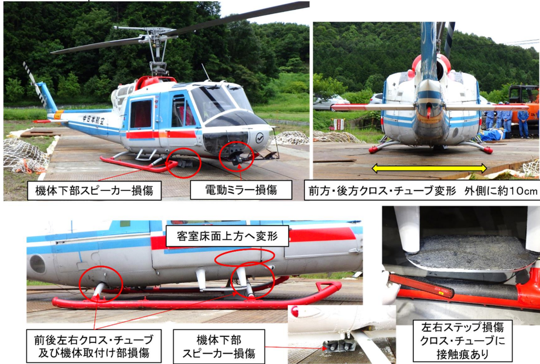
図4 機体の損壊と接地状態
