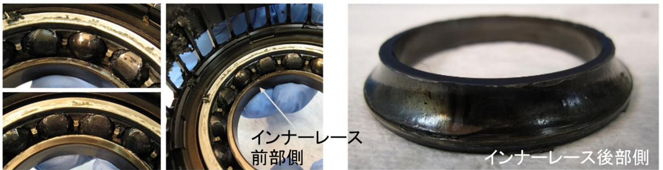
図G No.1 ボール・ベアリングの損傷状態
