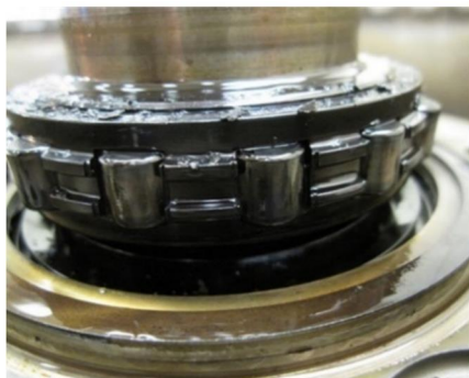
図H No.2 ローラー・ベアリングの状態
