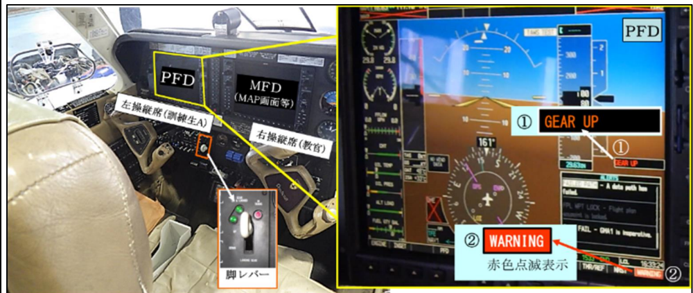
図9 作動確認時における脚警報の表示状況（同機）
