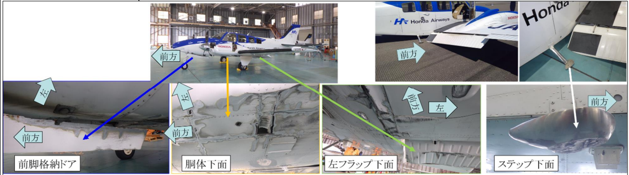
図5 胴体下面の損傷状況
