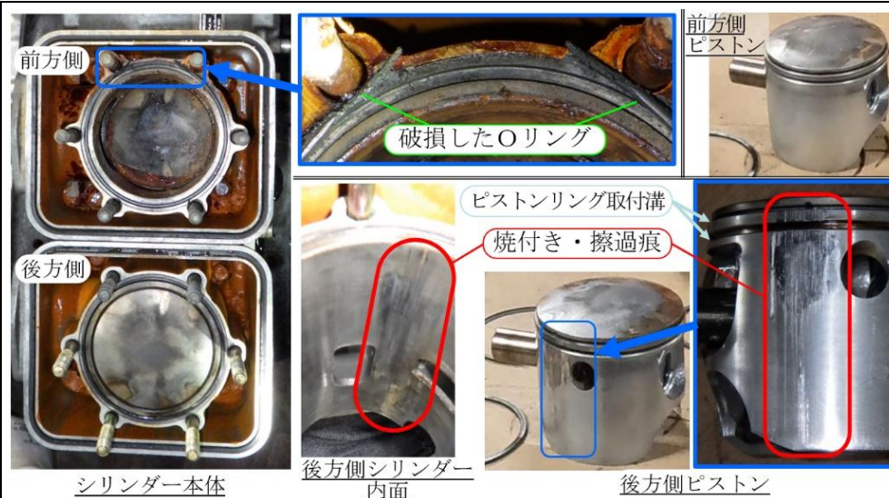
図 1 0 燃焼室シリンダー及びピストン
