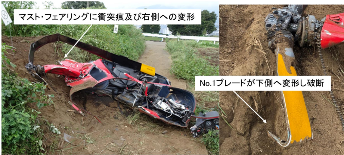
図3 事故現場での同機の墜落状況
