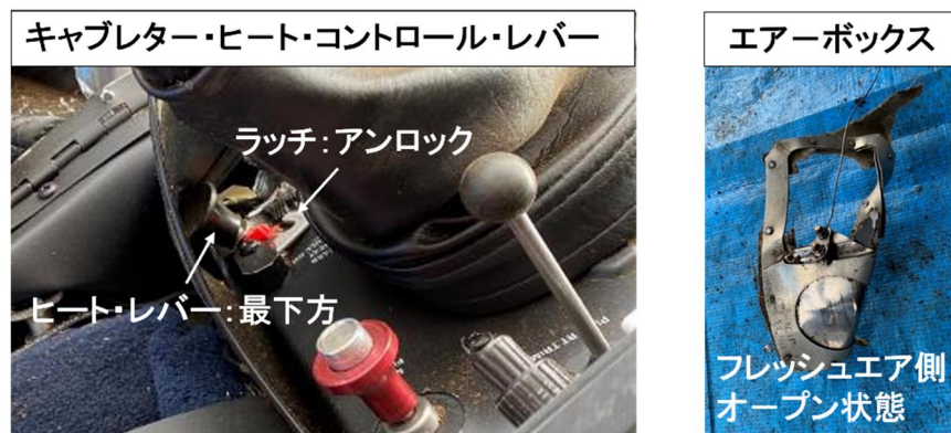
図17 キャブレター・ヒートの使用状態
