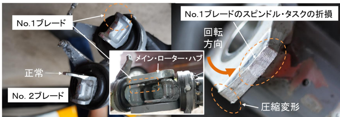
図14 スピンドル・タスクの損傷状態
