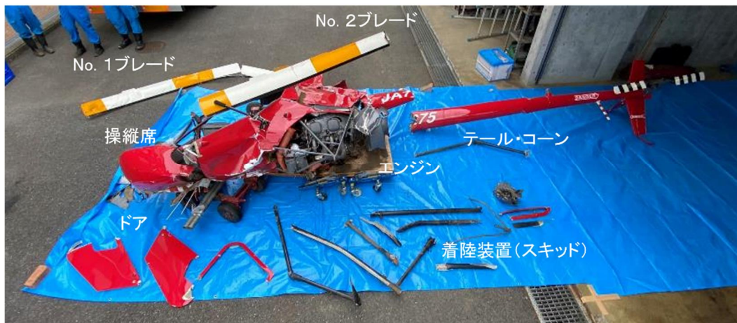
図9 残骸の再配置による損壊状況
