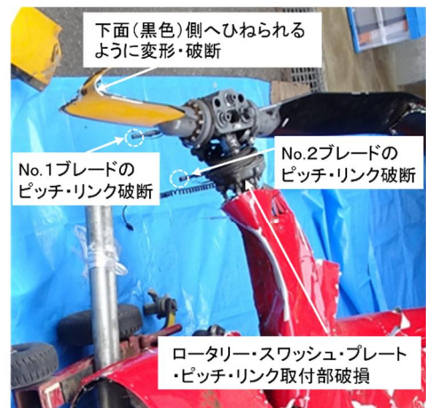
図12 メイン・ローター・ハブ周辺の破断状態
