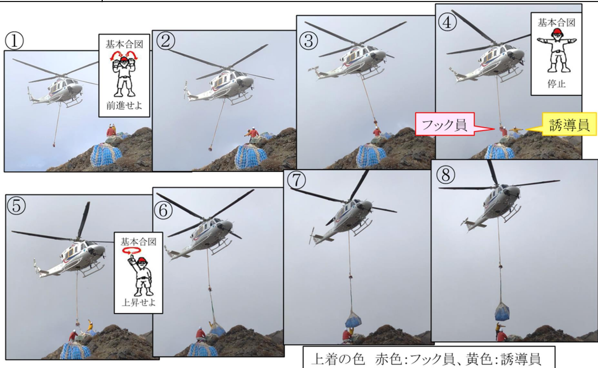
① ②同機が近接 ③ 誘導員がフックを取る ④ フック員がモッコ1をフックに掛ける ⑤ フック員退避、張り合わせ(上昇開始) ⑥ モッコ1が浮揚 ⑦ 誘導員がモッコ1につかまる ⑧ 手を離す
