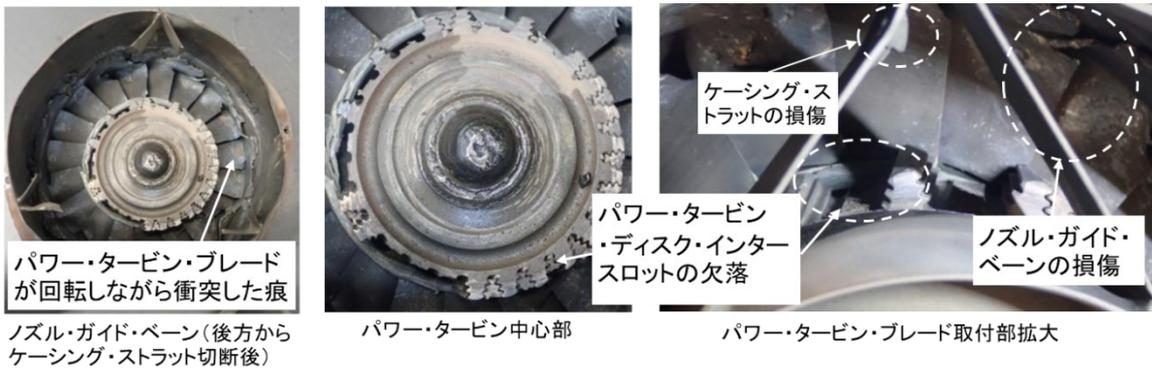
図B モジュールM04 パワー・タービン部の損傷
