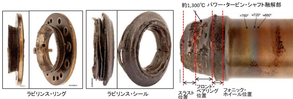
図D モジュールM04 パワー・タービン・シャフトの損傷
