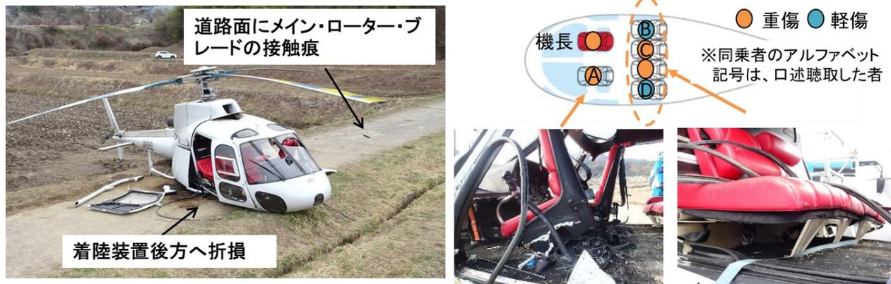
図6 操縦席及び客室付近の損傷
