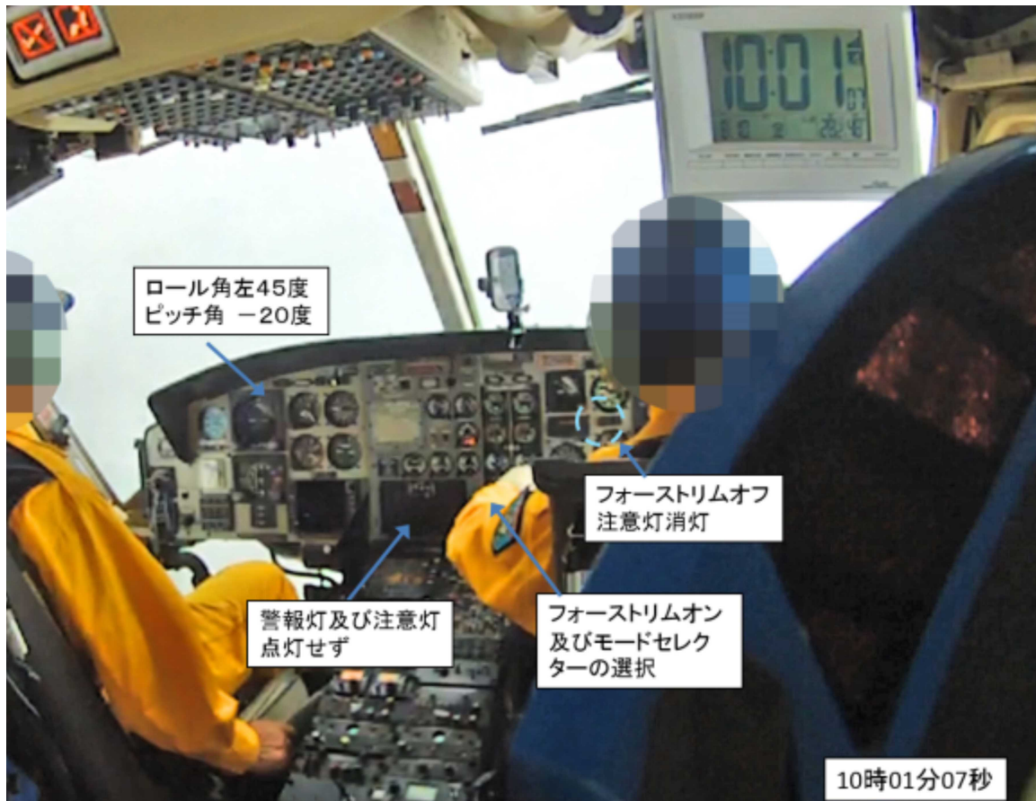
図5 墜落前フォーストリム及びモードセレクトターの操作
