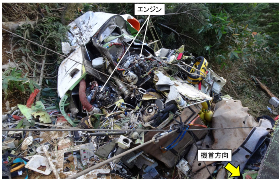
図6 事故現場における機体損傷状況
