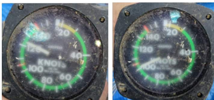
図 2 5 左操縦席対気速度計
