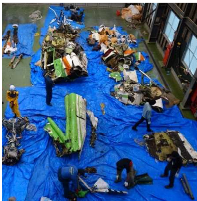
図14 詳細調査による残骸の再配置
