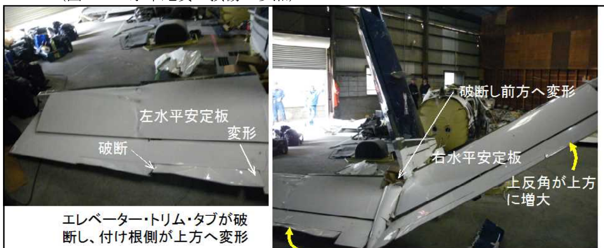
図15 水平尾翼の損傷
