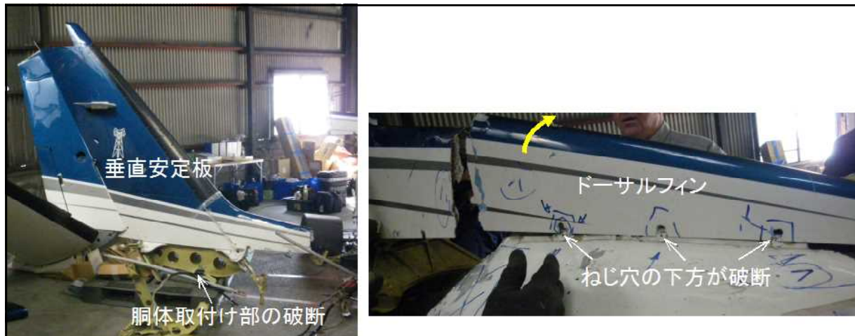
図16 垂直尾翼の損傷
